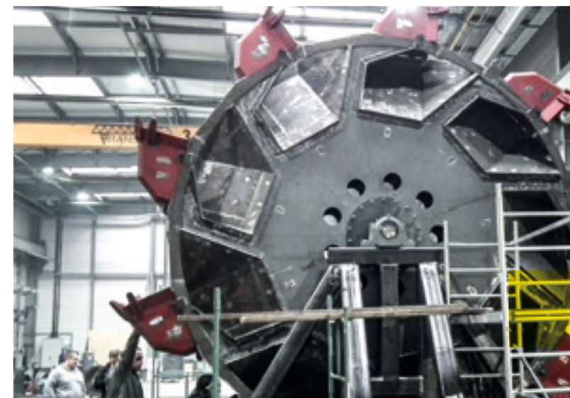
Uma roda de pás em estrutura soldada de KALMETALL feita sob medida
